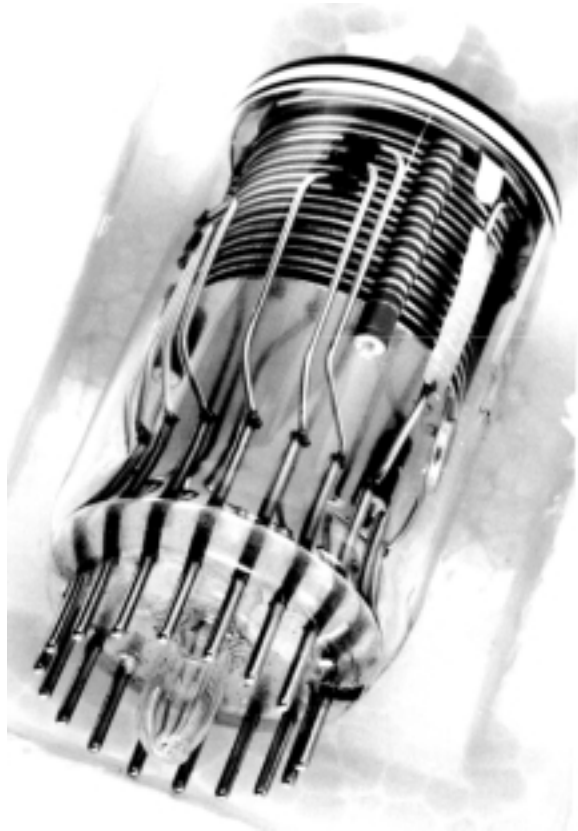
Abbildung 2.7: Photographie eines Hamamatsu R 5505 Photomultipliers
