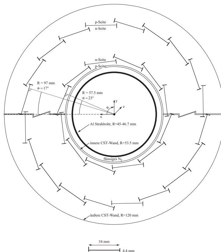
Abbildung 2.5: Schematische Darstellung des zentralen Silizium Vertex Detektors (CST).
