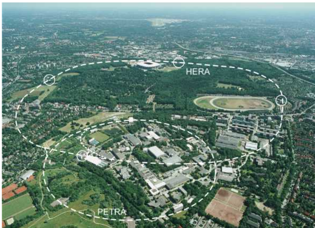
Abbildung 2.1: Der Speicherring HERA, im Bildvordergrund der Speicherring PETRA, der als Vorbeschleuniger dient. An HERA befinden sich die vier Experimente (im Uhrzeigersinn von links) H1, HERMES, ZEUS und HERA-B.
