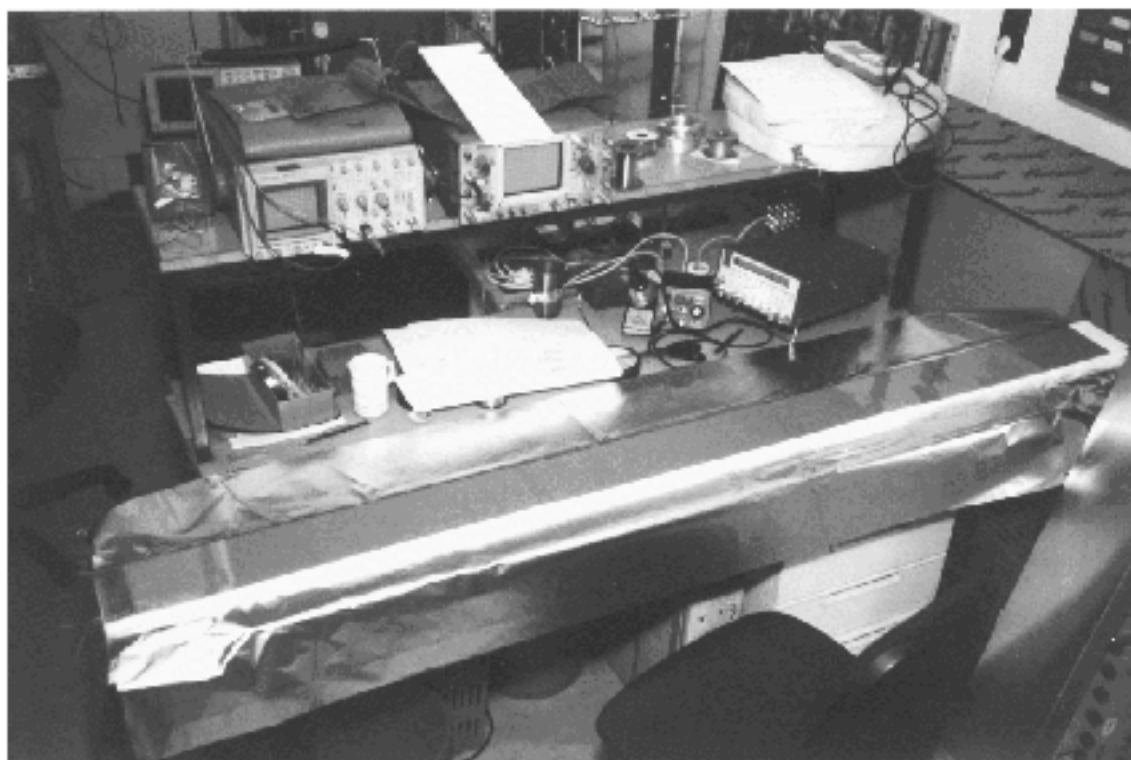
Abbildung 7.4.: Der Kammerlagen-Prototyp beim Zusammenbau. Obenauf befindet sich die Kaptonfolie mit den drei Pads.
