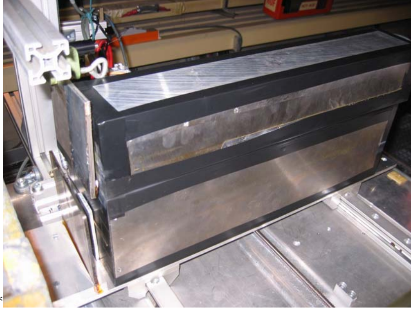
FIG. 3.35 – Photographie représentant les deux calorimètres protégés par une feuille de tungstène.
