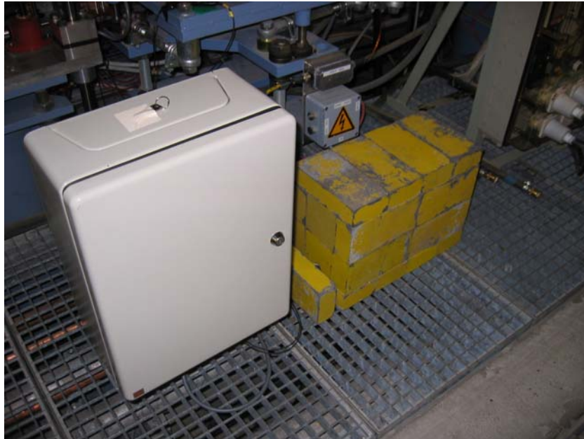
FIG. 3.34 – Ancienne boîte (à gauche), et nouvelle boîte en plomb (de couleur jaune à droite) accueillant la carte driver.
