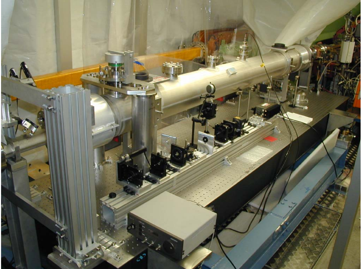
FIG. 2.8 – Image de la cavité prise durant l'installation. Les éléments laser et optique avant l'introduction dans la cavité sont situés sur des bancs parallèles à l'enceinte de la cavité. Le faisceau issu de la diode laser rouge, utilisé pour aligner les miroirs de la cavité, pénètre à l'intérieur de la cavité par l'entrée opposée. Ce laser de taille réduite est présent sur cette image. Il se situe entre le banc d'optique et l'enceinte de la cavité, sur un support qui dépasse en hauteur le banc.
